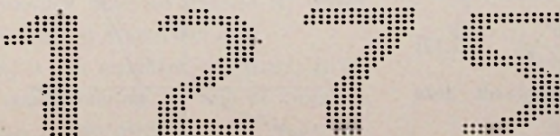
ISO B schrift en het patroon zoals het door het herkenningssysteem wordt „gezien“.
